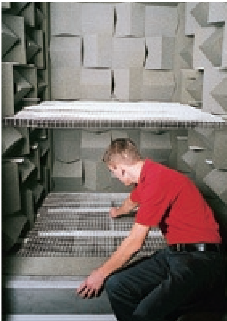
Innenansicht einer MINI-Freifeld-Kabine
