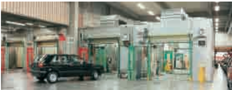
Rollenprüfstände bei Volkswagen, Brüssel, für die Endkontrolle
