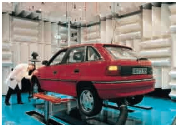
Reflexionsarmer Schallmessraum als Halbraum bei Delphi Automotive Systems in Luxemburg
