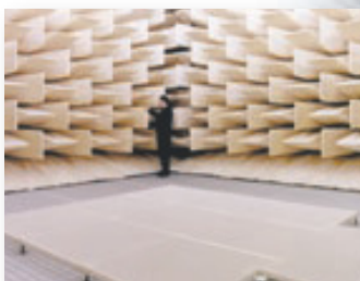
Telekom Freifeld-Akustik-Kammer n.d. Raum-in-Raum-Konzept, 10,2m x 10,2m x 10,2m hoch, f_u = 40 Hz
